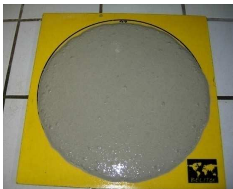
Figura 1 – Espalhamento obtido pela argamassa autonivelante M1 no tempo T=0
