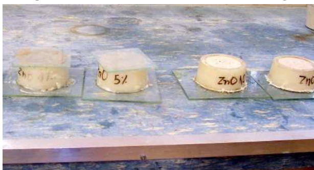
Figura 2 - Tempos de pega: Pastas de cimento aluminoso com óxido de zinco
