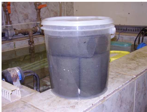
Figura 3 - Cura dos corpos-de-prova para avaliação da resistência mecânica
