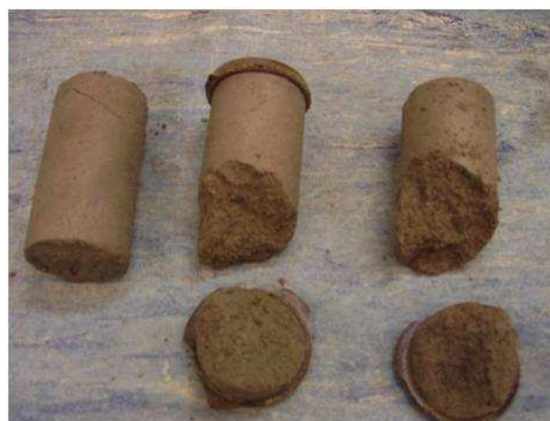
Figura 5 – Corpos de Prova de Cimento Portland com 10% de óxido de zinco aos 7 dias
