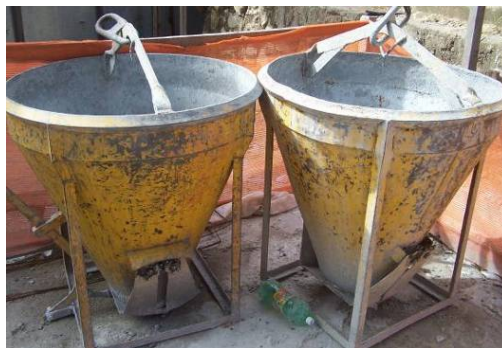
Figura 6 – Caçambas de içamento de material
