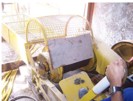
Figura 4 – Improviso no isolamento do cabo de aço dos elevadores
