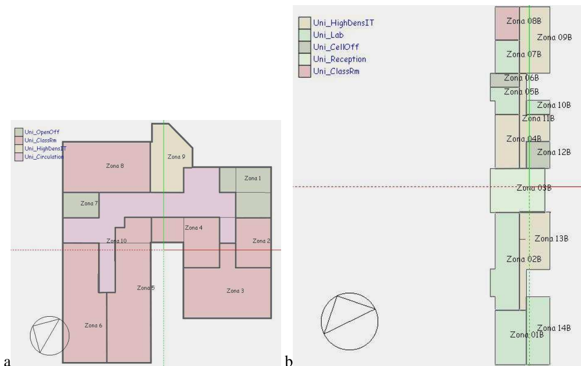
FIGURA 7. Esquema das multi-zonas térmicas (DesignBuilder): a. edifício G1 (pav. sup.); edifício L1 (pav. sup.), sem escala.
