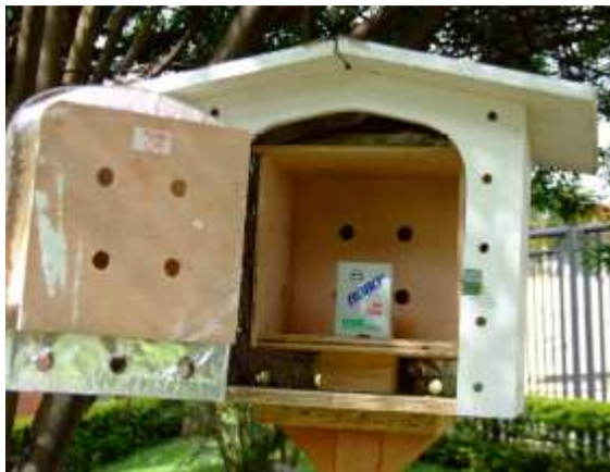
FIGURA 2: Abrigo Meteorológico Fonte: Gomes, 2008
