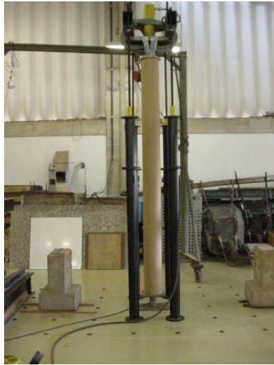
Figuras 6 e 7 – Corpo-de-prova antes da aplicação de carga e após o início da flecha.
