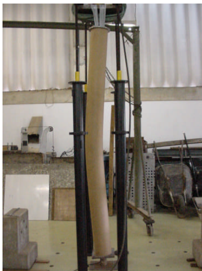
Figuras 10 e 11 – Tubo totalmente flambado e sem estabilidade e tubo rompendo com o acréscimo de carga.
