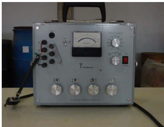
Figura 5 – Equipamento Transdutec utilizado no ensaio de flambagem.
