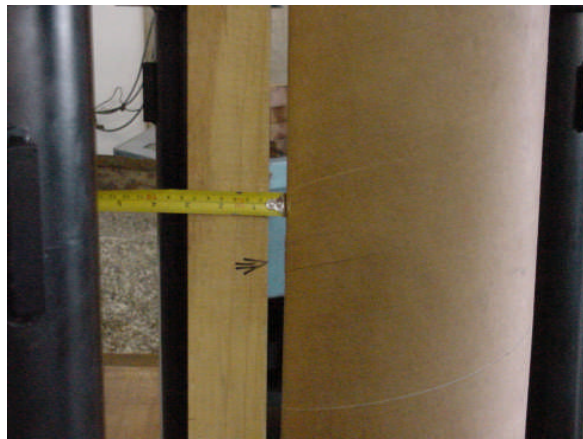
Figura 8 – Medição da flecha gerada no corpo-de-prova devido ao carregamento.
