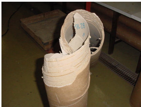
Figura 12 – Corpo-de-prova rompido durante o ensaio de flambagem.
