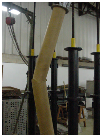
Figuras 10 e 11 – Tubo totalmente flambado e sem estabilidade e tubo rompendo com o acréscimo de carga.
