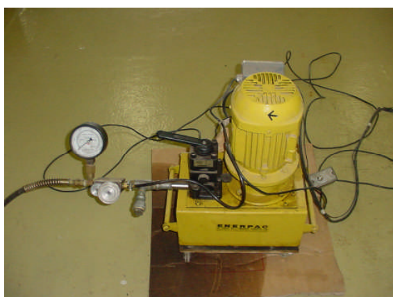
Figura 4 – Bomba eletro-hidráulica utilizada no ensaio de flambagem.
