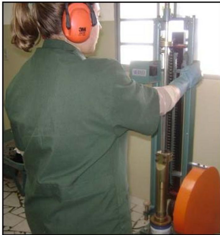
Figura 4 – Compactação da mistura com soquete elétrico, com peso de 4,54 Kg, caindo em queda livre da altura de 45,72 cm.
