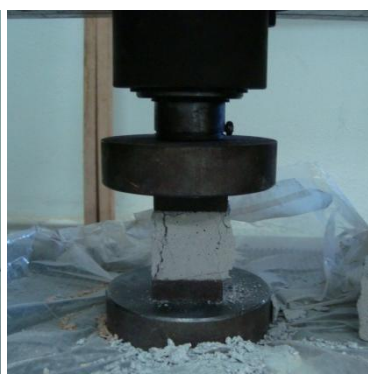
Figura 5 - Rompimento do corpo de prova
