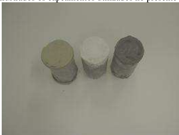
Figura 1- Corpos de prova de argamassa capeadas com enxofre, pasta de gesso e pasta de cimento (da esquerda para a direita).
