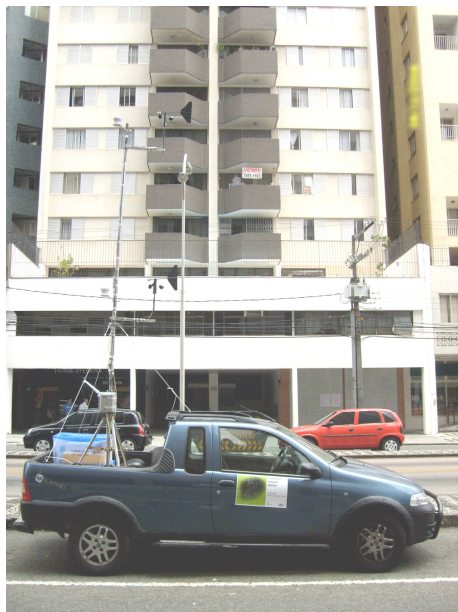
Figura 3 – Plataforma de medição meteorológica acoplada a uma picape
