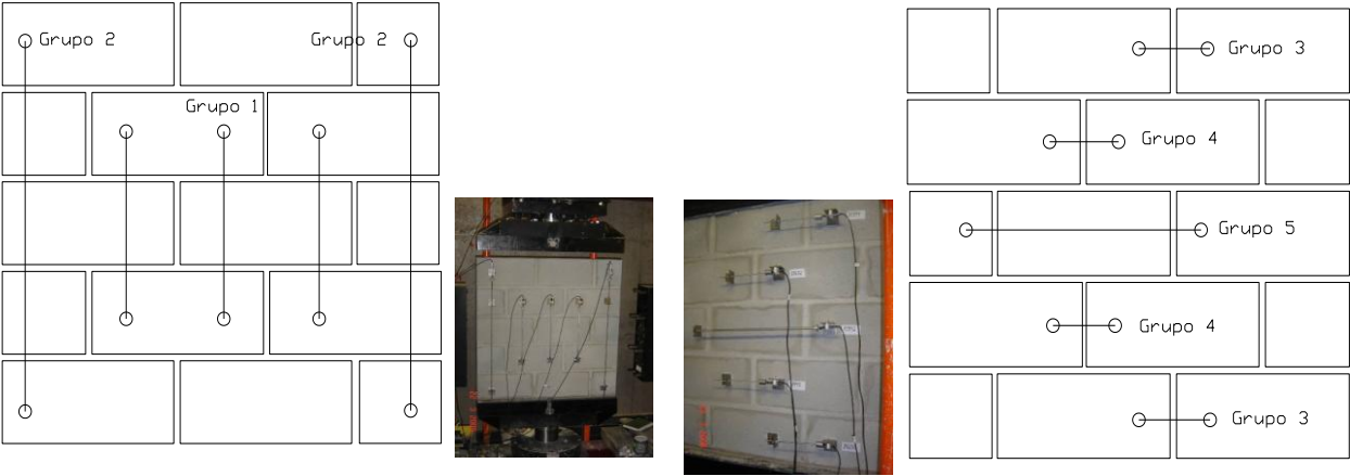
Figura 3 - Esquema geral do ensaio de compressão uniaxial de paredes
