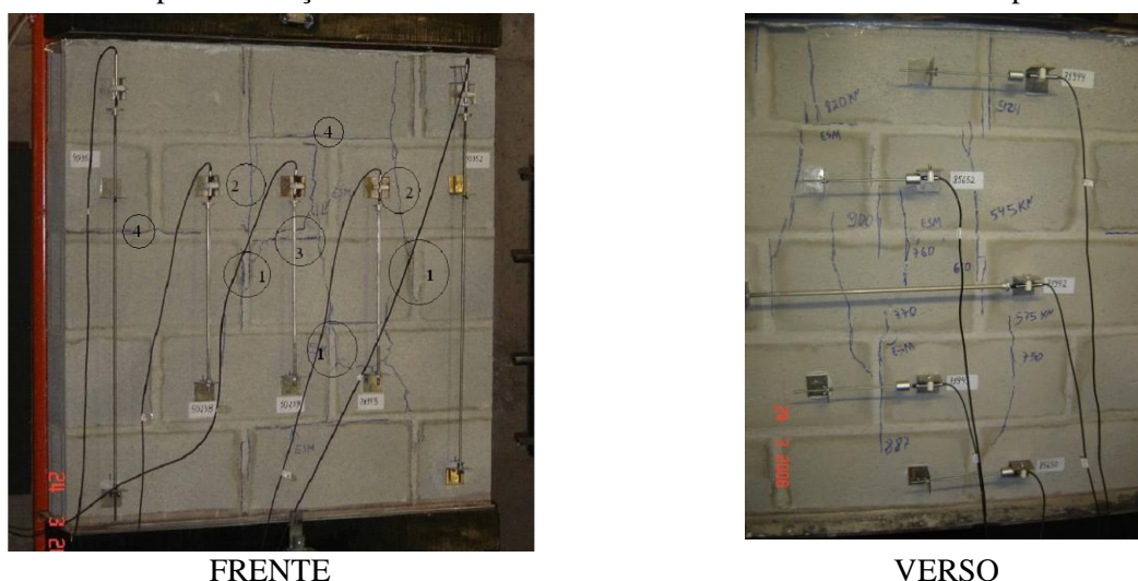
Figura 5 - Parede de 1m por 1m, modo de ruptura
