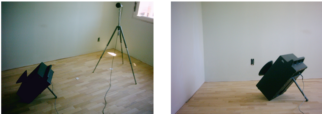
Figura 1 - Descrição da montagem de equipamentos e medição da isolamento acústico de parede de alvenaria.
