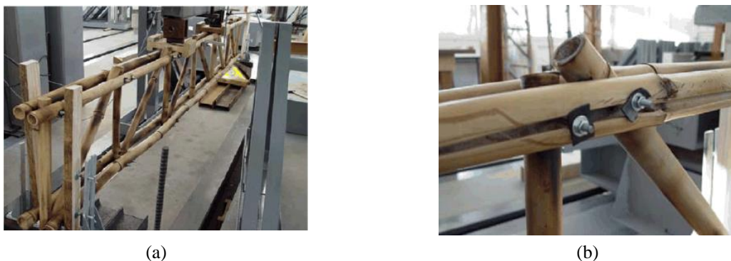
Figura 9 – Viga treliçada sem reforço sendo submetida ao ensaio de flexão (a) e detalhe da ruptura da área de ligação após o ensaio (b)
