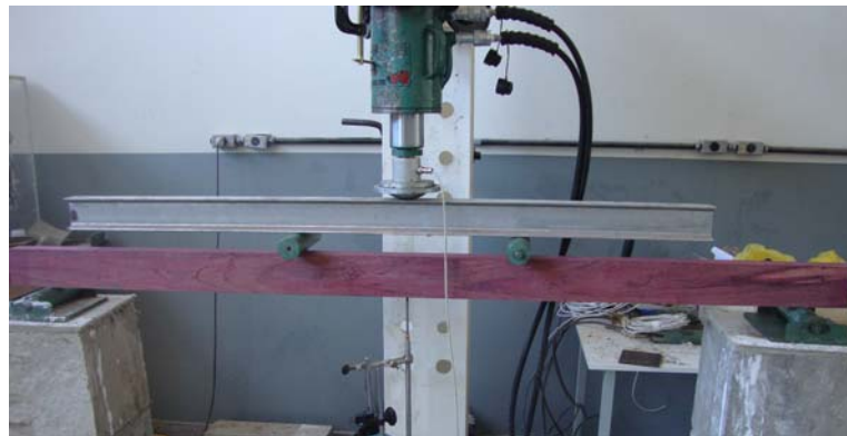
Figura 3 – Viga sem reforço sob duas forças concentradas.
