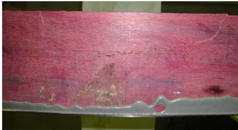
Figura 4 – Detalhe do modo de ruptura por compressão de viga com reforço.
