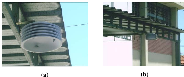
Figura 09 – Medições externas: detalhe da proteção do registrador de temperatura (a) e visão geral do posicionamento do mesmo (b)
