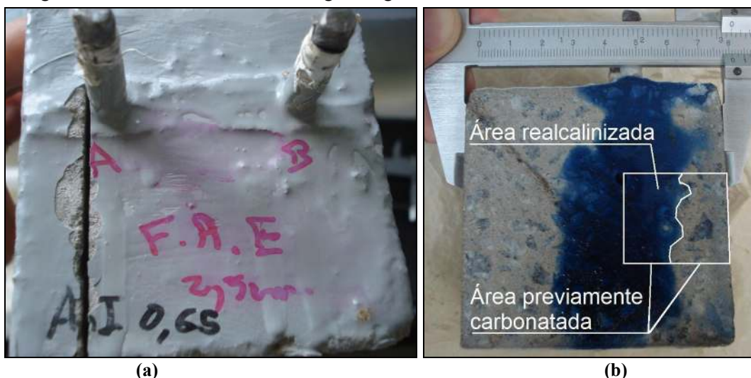
Figura 3 - Avaliação do avanço da frente de realcalinização no concreto através do emprego de solução indicadora de timolftaleína a 1%.
