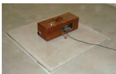
Figura 5 - Ensaio de isolamento ao ruído de impacto.
