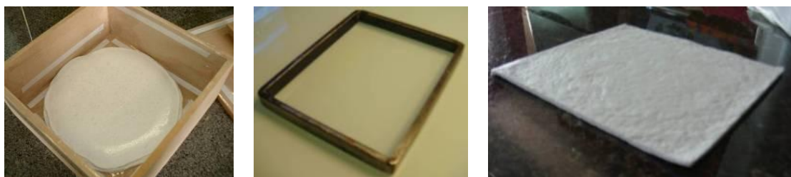
Figura 4 – Finalização das placas de PU: (a) caixa de madeira com a mistura de PU, (b) molde e (c) placa de PU nas dimensões 16 x 13 cm
