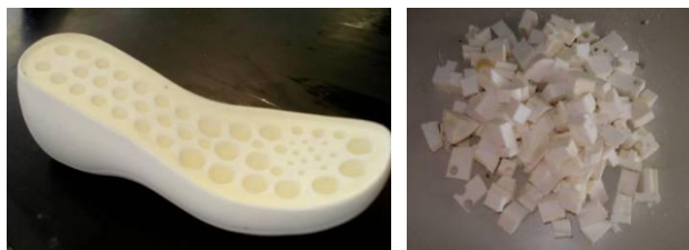
Figura 3 - Solado de Sapato (a) resíduo de PU; (b) pedaços cortados na serra-fita
