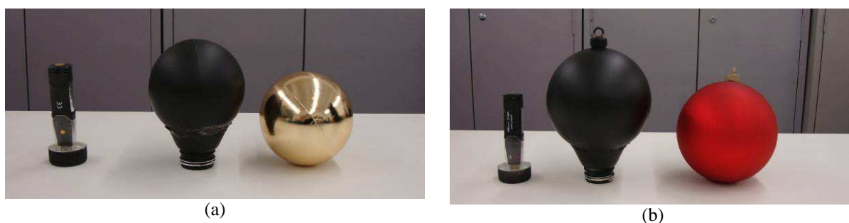
Figura 2 – Globos negros alternativos e os termo-higrômetros com data logger
