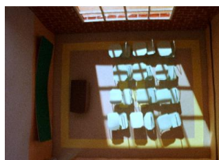
Figura 8: Simulação física sem proteção. (solstício de verão)
