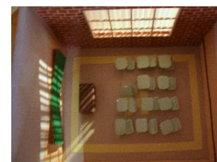
Figura 15: Simulação física com proteção. (solstício de inverno)
