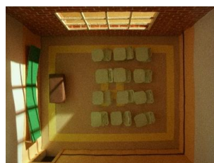
Figura 14: Simulação física sem proteção. (solstício de inverno)
