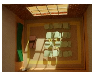
Figura 11: Simulação física sem proteção. (equinócios)
