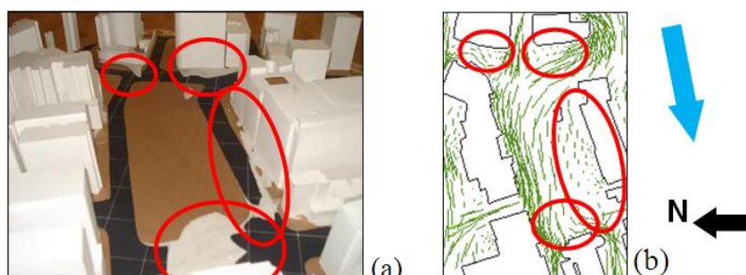
Figura 18. Resultados para o Largo do Machado: arrasto de areia (a) e simulação computacional (b).
