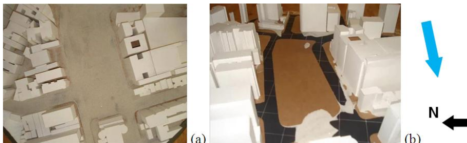
Figura 17. Maquete coberta com fina camada de areia (a) e resultados do experimento com a areia permanecendo nas regiões menos ventiladas.
