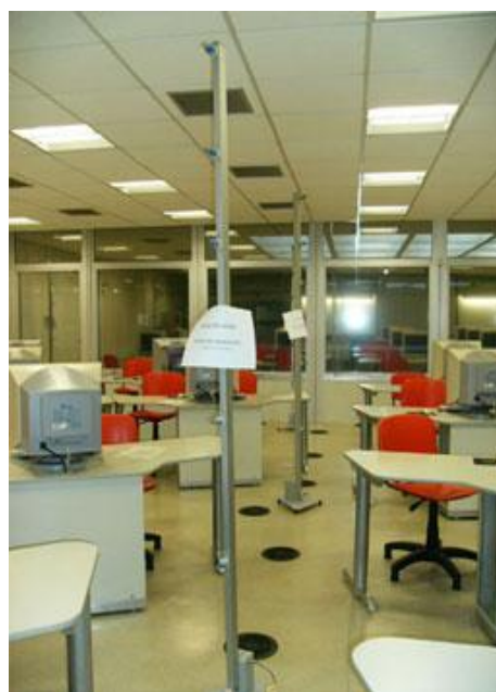
Figura 3 – Hastes de suporte dos sensores de temperatura e velocidade do ar
