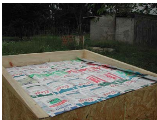
Foto 1 – Uso de manta feita com reaproveitamento de embalagens do tipo Tetra Pak
