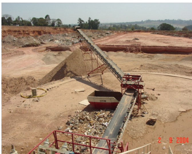
Figura 1: Exemplo de produção de brita corrida reciclada na usina de Campinas/SP, sem controle granulométrico.
