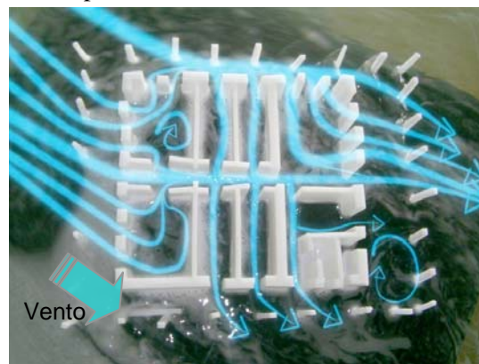
Figura 22 - Simulação do comportamento dos ventos na planta baixa, submetida à orientação Sudeste.
