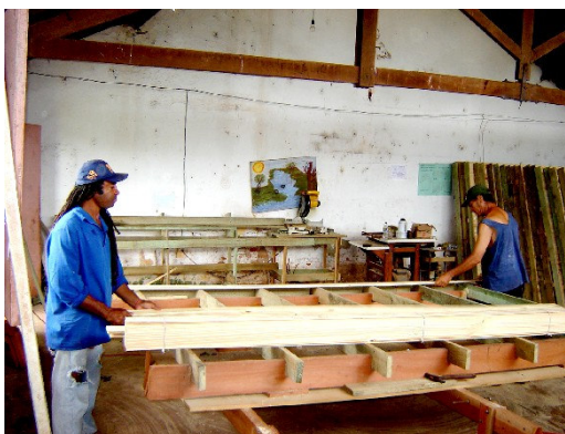
Figura 4 – Mesa de produção dos painéis (MPP) - momento da distribuição do forro sobre os caibros
