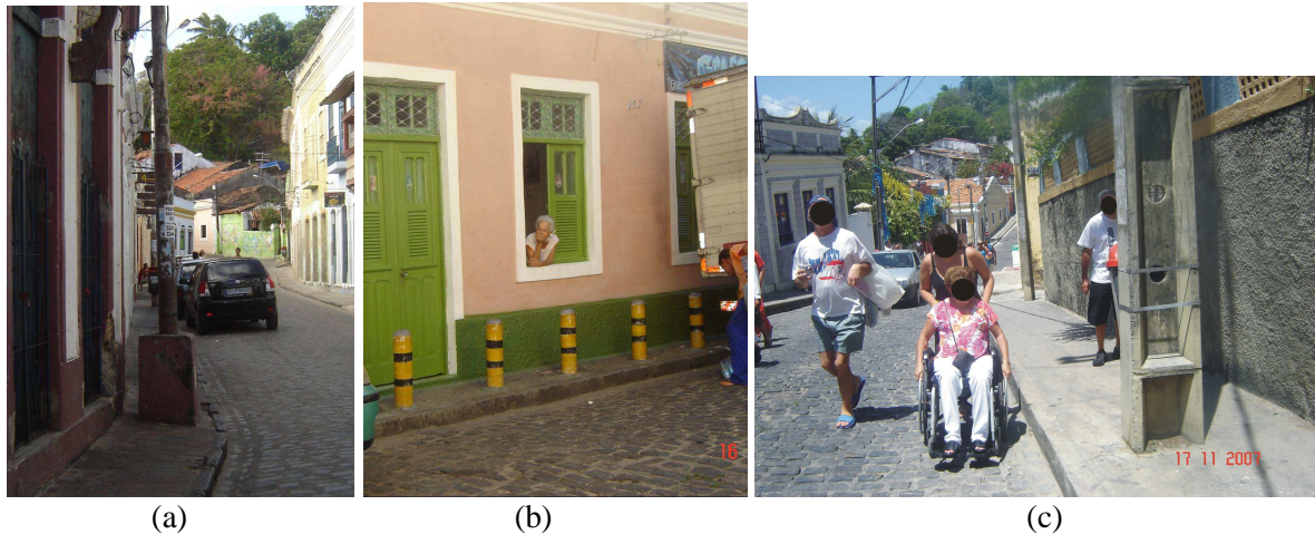
Figura 5 - Mobiliário urbano obstruindo a circulação nas calçadas, como por exemplo, postes (a) e fradinhos (b), que impedem a circulação de usuários de cadeiras de rodas nas calçadas (c)
