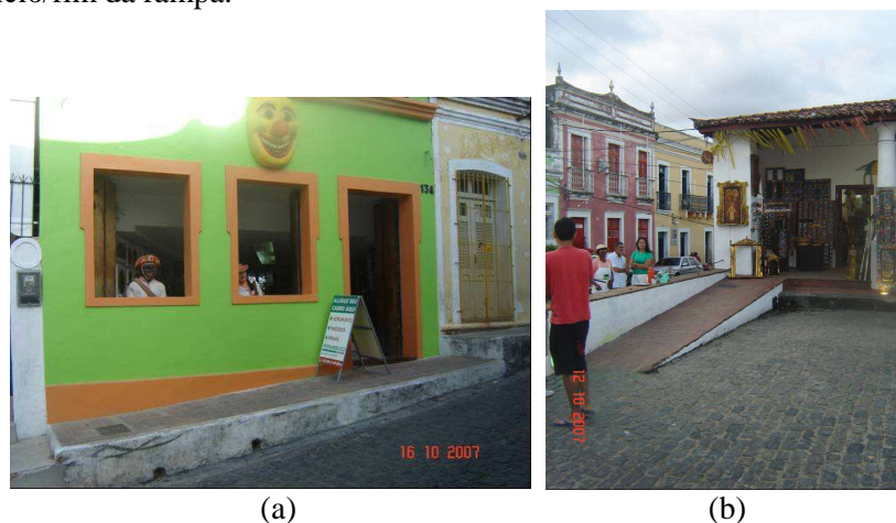
Figura 6 - Exemplos de barreiras físicas: obstrução da área de circulação pública por mobiliário móvel (a) e obstrução da rampa por objetos colocados na passagem (b)
