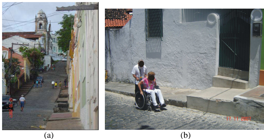
Figura 4 - Calçadas sem corrimãos para auxiliar o deslocamento das pessoas (a), onde são instalados degraus, forçando o deslocamento de usuários de cadeira de rodas por meio das vias (b)
