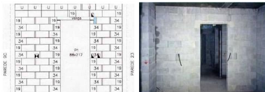
Figura 3 - Engenharia Simultânea - alvenaria estrutural e elétrica
