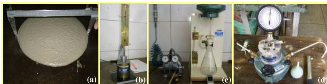
Figura 3 - Ensaios de caracterização da argamassa no estado fresco: (a) espalhamento na mesa ABNT, (b) penetração do cone, (c) retenção de água, (d) teor de ar pelo método pressométrico.
