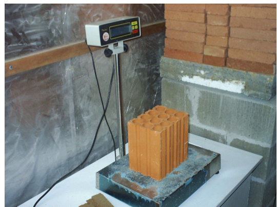
Foto 4 – Obtenção das medidas de planeza e massa dos blocos cerâmicos
