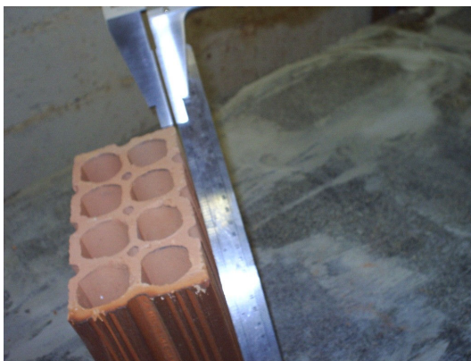
Foto 4 – Obtenção das medidas de planeza e massa dos blocos cerâmicos
