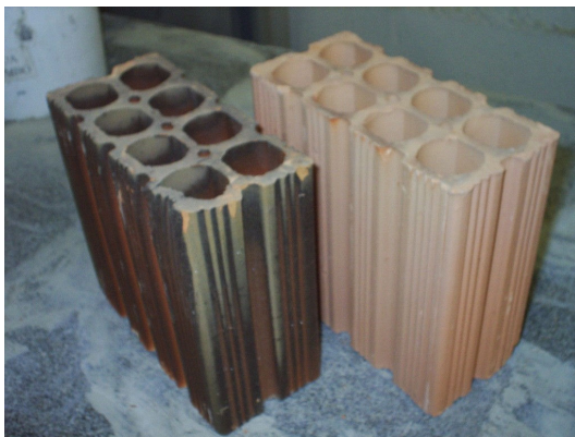
Foto 5 – Defeitos visíveis (queima diferenciada e quebras) nas unidades
