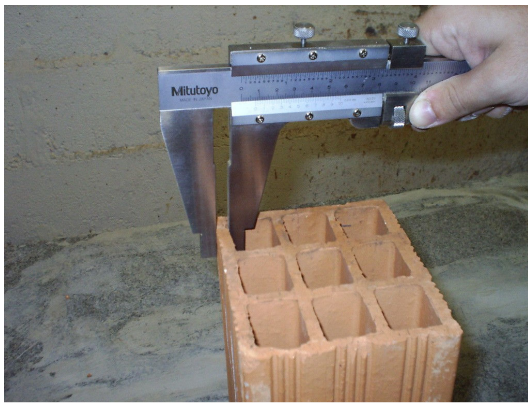
Foto 3 – Obtenção das dimensões das paredes dos blocos cerâmicos
