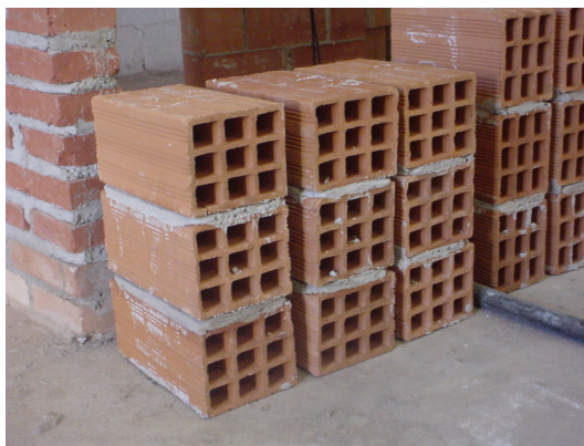
Foto 7 – Corpos de prova: Prismas de tijolos maciços e blocos cerâmicos
