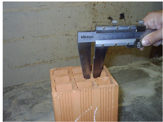
Foto 3 – Obtenção das dimensões das paredes dos blocos cerâmicos
