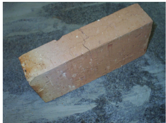
Foto 5 – Defeitos visíveis (queima diferenciada e quebras) nas unidades
