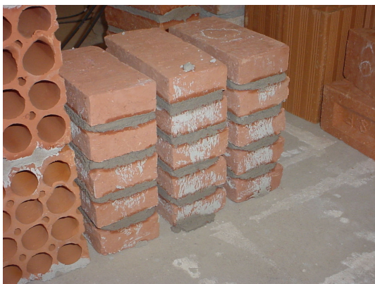
Foto 7 – Corpos de prova: Prismas de tijolos maciços e blocos cerâmicos
