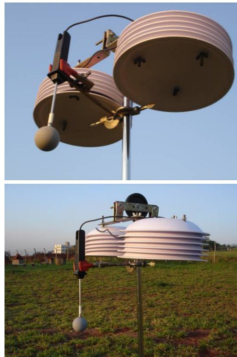
Figura 07 - Tripé fixado com registradores protegidos
