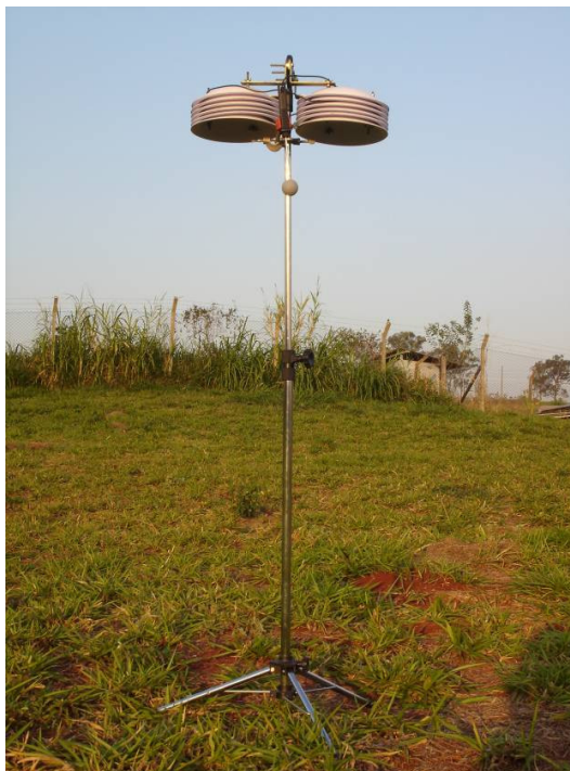
Figura 07 - Tripé fixado com registradores protegidos
