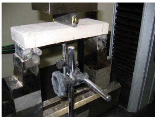
Figura 2 - Ensaio de módulo à tração na flexão, com medidor de deslocamentos do tipo LVDT.
