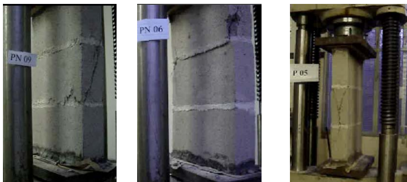
Figura 4 - Ruptura dos prismas sem revestimento
