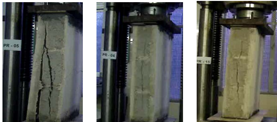
Figura 5 - Ruptura dos prismas com revestimento, sem tela
