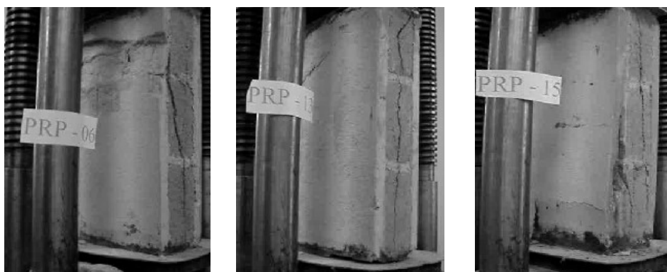
Figura 7 - Ruptura dos prismas com revestimento com tela eletrosoldada de aço
