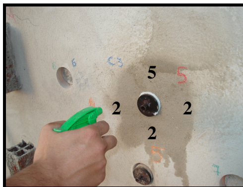
Figura 2 – Preparação do revestimento na condição úmida, por meio de borrifadas, para a realização do ensaio de resistência de à tração superficial.
