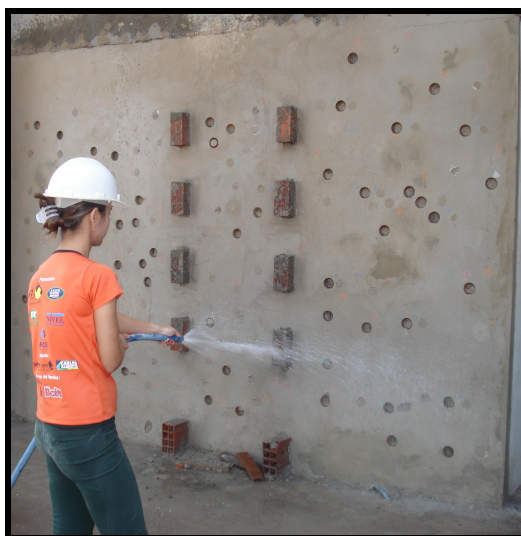
Figura 3 – Preparação do revestimento na condição saturada, executado com auxílio de jato de água de mangueira.
