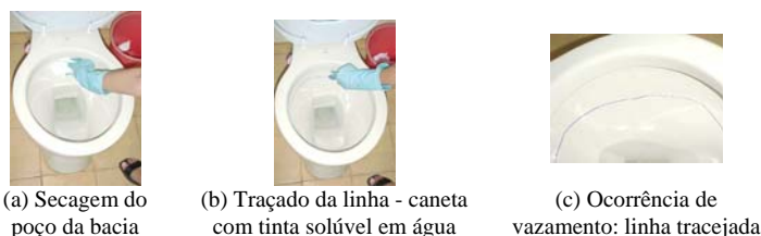
Figura 1 – Teste da caneta – detecção de vazamentos em bacias sanitárias.
