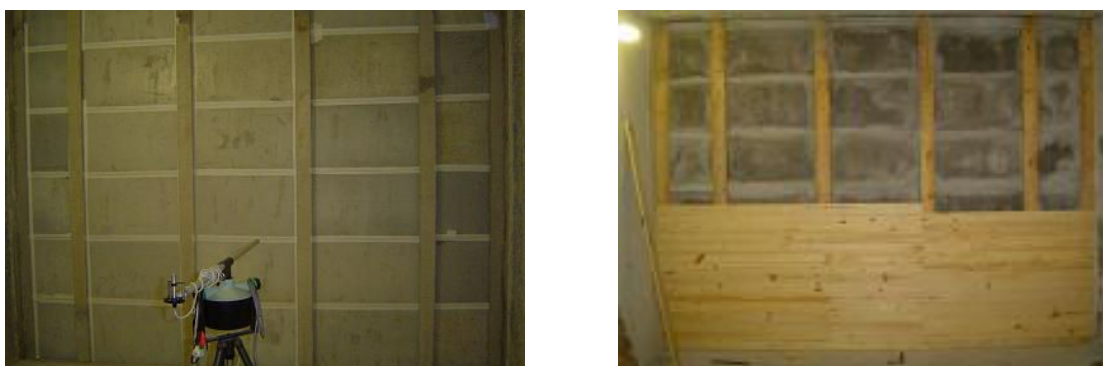
Figura 2: Parede vedada com fita crepe, vista da Câmara de Emissão e, construída com argamassa. Revestimento de madeira na Câmara de Recepção.
