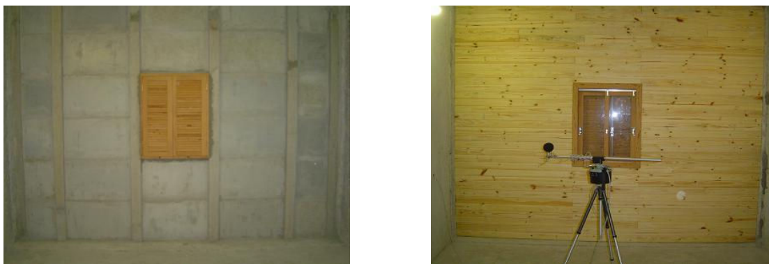
Figura 3: Parede argamassada, com janela, vista pelo lado da Câmara de Emissão e revestida em lambri de pinus na Câmara de Recepção.
