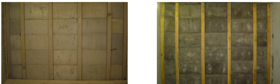
Figura 1: Parede executada com painéis simplesmente encaixados. À esquerda está a Câmara de Emissão e à direita, a Câmara de Recepção.
