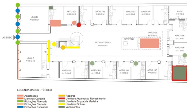
Fig.4 Mapeamento de danos no térreo. Adaptação dos autores, 2007
