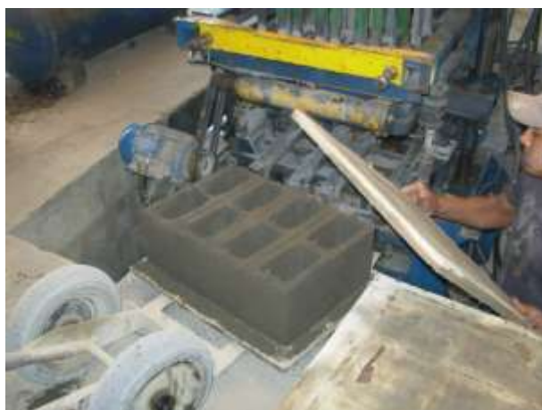
Figura 5 – Blocos de concreto (traço 0% de substituição).
