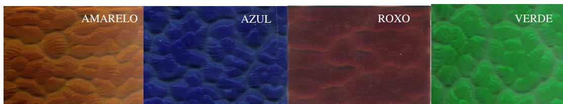
Figura 2 - Vidros impressos árticos coloridos ensaiados
