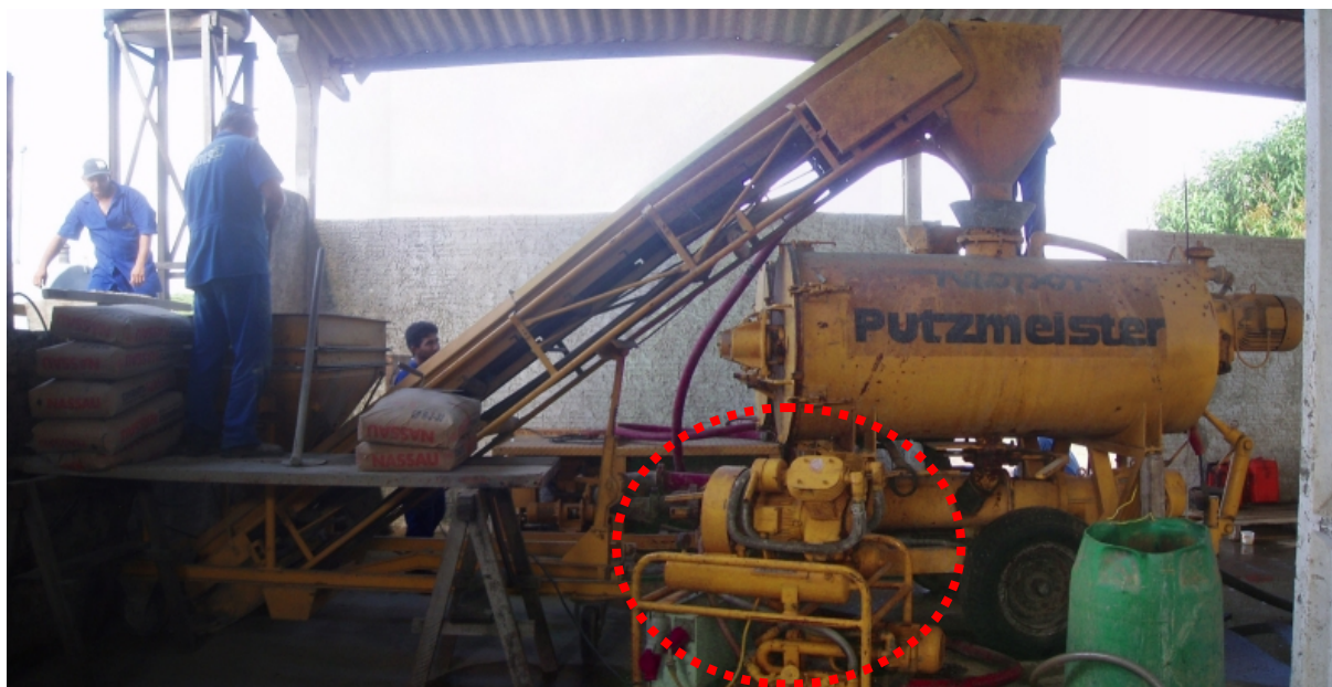
Figura 3 – Gerador de espuma (em destaque) e misturador
