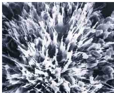
Figura 4 – No corpo de prova, 26 dias após a aplicação do sistema de cristalização.
