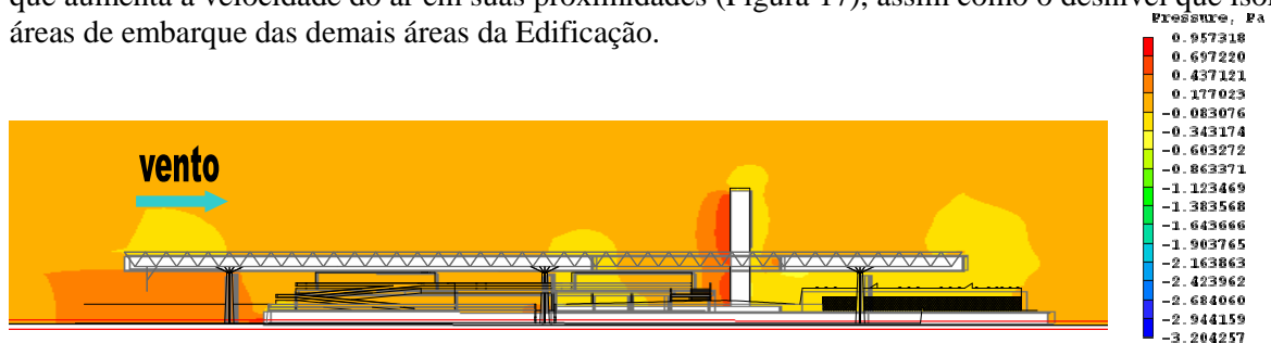
Figura 17: Corte esquemático apresentando os campos de pressão para o Terminal Rodoviário de Maceió, a partir da incidência dos ventos na direção sudeste
