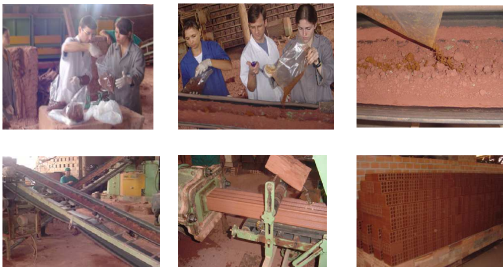
Figura 1 – Moldagem dos blocos cerâmicos com adição de lodo de fosfatização
