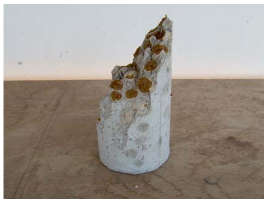
Figura 8 – Visão do ângulo de ruptura do corpo de prova do concreto produzido com o composto
