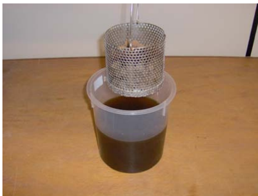
Figura 5 – Aplicação do óleo de linhaça no agregado
