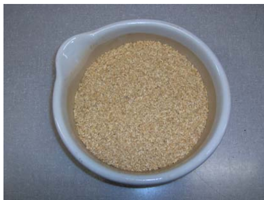
Figura 4 – Serragem de madeira da espécie Pinus utilizada no desenvolvimento e produção do compósito.
