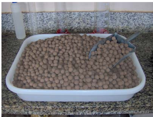
Figura 6 – Composto a base de lodo de estação de tratamento de água, serragem de madeira e óleo de linhaça
