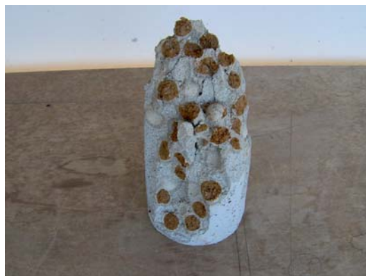
Figura 7 – Visão da superfície de ruptura do corpo de prova do concreto produzido com o composto
