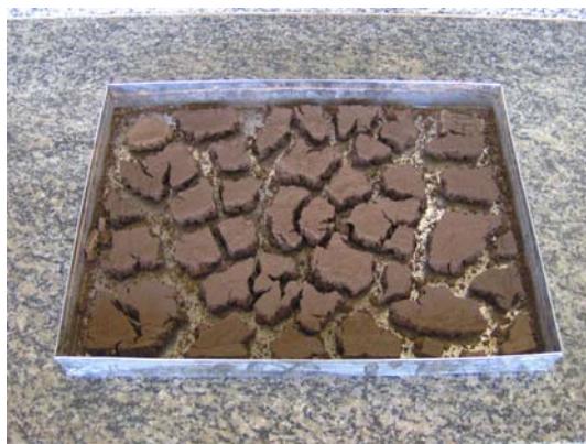
Figura 3 – Fase sólida do lodo após completamente seco em estufa a temperatura de 105 \pm 05^{\circ}\text{C} .
