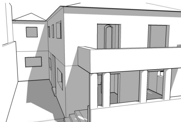
Figura 8 – Modelo simplificado da casa, com simulação da incidência solar por volta das 11:00hs, sem interferência da vegetação.
