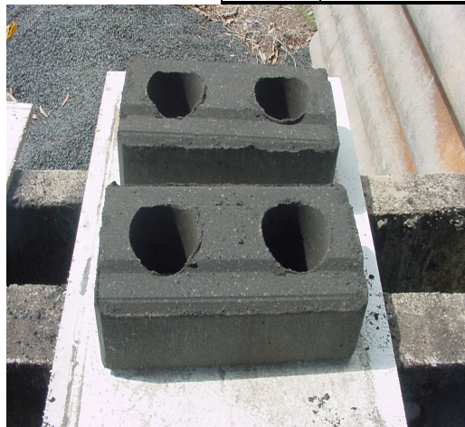
Figura 3 – Tijolos maciços após fabricação
