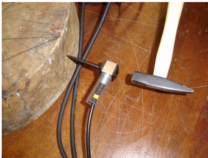
Figura 5 – Aplicação da onda sonora.
