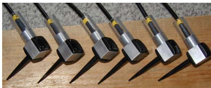
Figura 2 – Sensores de emissão e recebimento da onda sonora.
