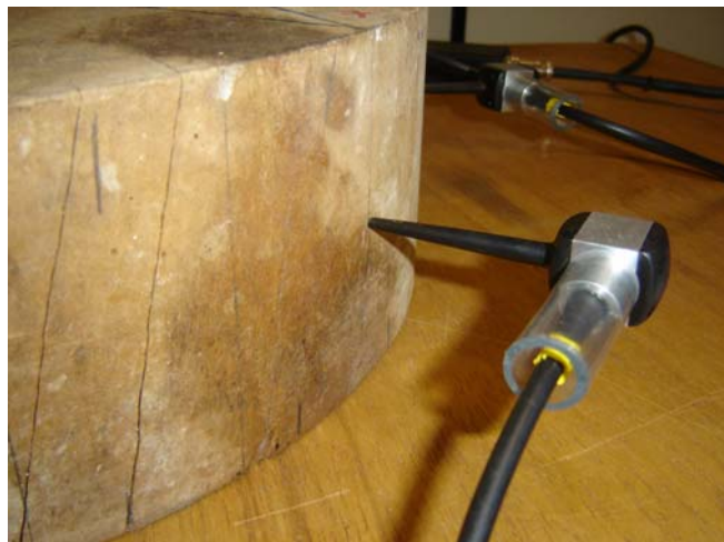
Figura 4 – Posicionamento do sensor na peça de madeira.
