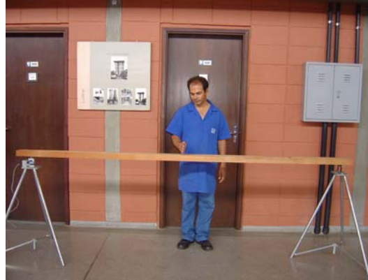
Figura 2 - Ensaio de vibração transversal.
