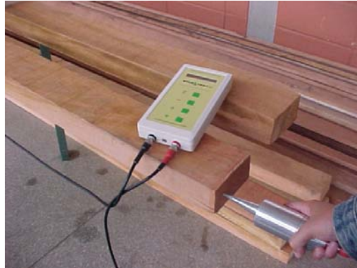
Figura 1 - Ensaio de ultra-som.
