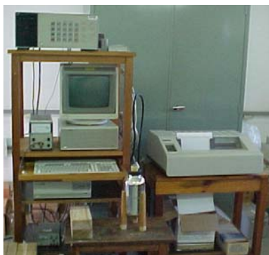
Figura 2 - Equipamentos utilizados para determinação da condutividade térmica, PINTO (2005).
