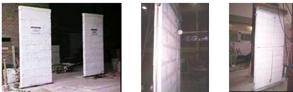
Figura 3 - Detalhe dos painéis prontos para serem ensaiados à resistência a compressão.
