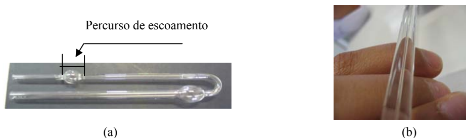
Foto 1 – Viscosímetro de Ostwald. (a) aspecto do percurso. (b) aspecto do capilar.
